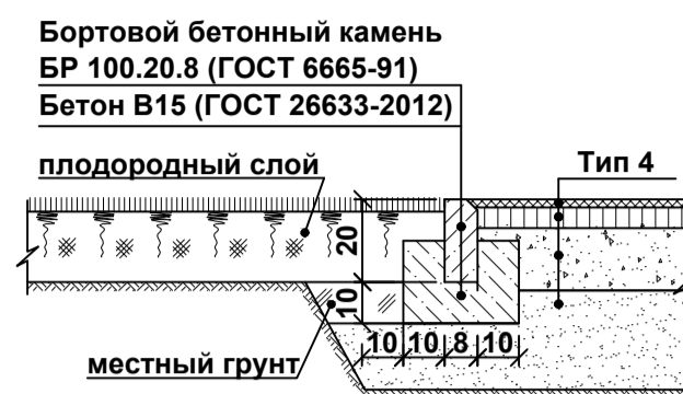
Узел сопряжения площадки с резиновым покрытием с газоном (в уровень) на эксплуатируемой кровле гаража 1:20
