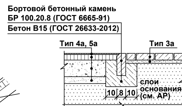
Узел сопряжения тротуара из плитки с резиновым покрытием (в уровень) на эксплуатируемой кровле гаража 1:20
